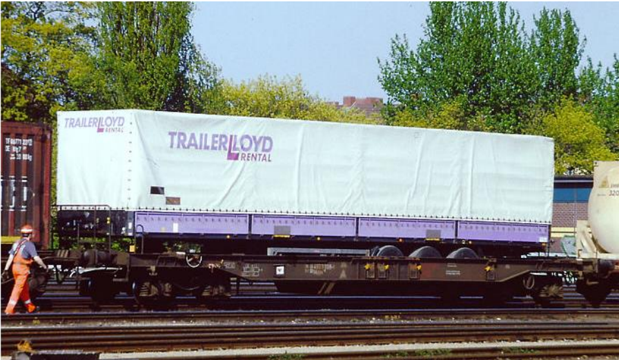
Fig. 3: Origina tipo de poŝvagono, Sdgkms. www.dybas.de
