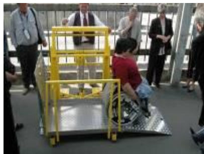
Bildo 10: Svisa movebla levplatformo Miro-lift
