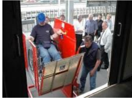
Bildo 6: Movebla levplatformo (ĉeĥa Delta B+B (1) )
