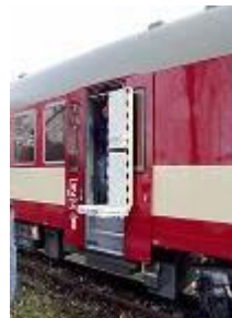
Bildo 4: Vagono s. 943 kun hidraŭlika platformo
